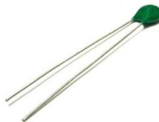
O grande problema dos termistores é que é necessária fazer uma função de calibração, pois a relação entre temperatura e resistência elétrica não é linear. Existe uma equação, chamada equação de **Steinhart-Hart** que é usada para descrever essa relação (vide referências).
