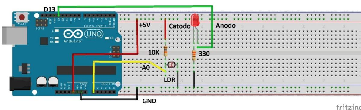
No diagrama, o sensor é ligado como parte de um divisor de tensão no pino analógico A0, de forma que a tensão de saída do divisor varia de acordo com a variação da
