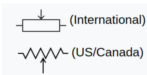
Nesse exemplo, vamos ligar a saída de um potenciômetro a uma entrada analógica da Arduino UNO. Dessa forma, vamos ler o valor de tensão na saída do potenciômetro e vê-la variando de
