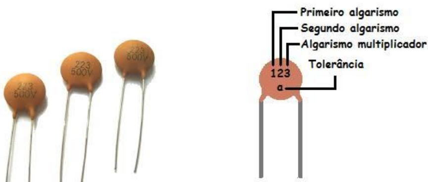
Figura 4: Capacitores cerâmicos
