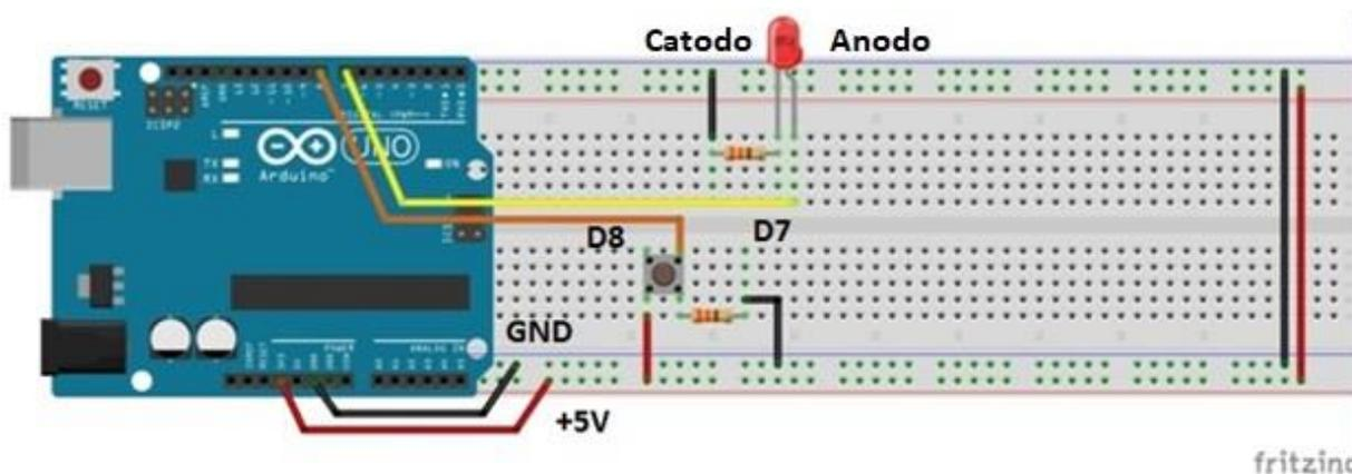
Esse pequeno código abaixo mostra como ler entradas digitais e com acionar as saídas digitais. Na função **void Setup()**, é preciso configurar qual pino será usado como saída e qual será usado como entrada.
