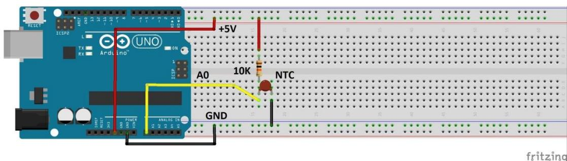
Para uma melhor precisão nas medidas de temperatura, meça a tensão de 5V no barramento do protoboard, usando um multímetro (não contém no KIT). Essa tensão é a mesma usada como referência do conversor analógico-digital do Arduino. Especifique esse valor de tensão na primeira linha do Sketch:
