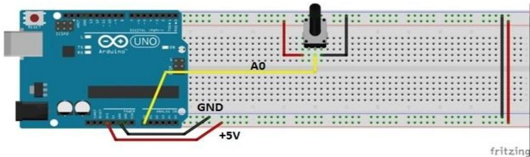
O Potenciômetro possui 3 terminais, sendo que o do meio é o que possui resistência variável. A ligação consiste em ligar os dois terminais fixos a um tensão de 5V. Assim, o terminal intermediário do potenciômetro terá um valor que varia de 0 a 5V à medida que você dá gira seu knob.
