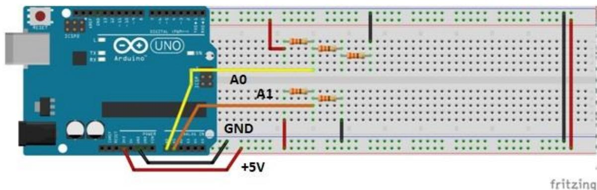
Esse é um diagrama com dois divisores de tensão. O primeiro é composto por três resistores, sendo cada um de 330. Assim, o resistor Z1 é de 330 e o resistor Z2 é a associação série dos outros dois, resultando numa resistência de 660. Dessa forma, a tensão de saída do divisor é:
