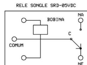
O terminal C é o Comum do Contato. Os outros dois terminais usamos para ligar ou desligar a carga. Se ligamos a carga no terminal NA, a carga será acionada setando o pino de controle do relé para nível alto. Se ligarmos a carga no pino NF, ela será ativada
