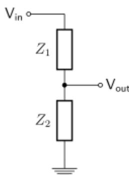
Um divisor de tensão muito comum é fazer Z1 igual 330 ohms e Z2 igual 680 ohms. Dessa forma a saída Vout fica sendo 3.336 V. Como no Kit Arduino BEGINNING não há resistor de 680ohms, você pode ligar um de 330ohms como Z1 e dois de 330ohms como Z2. Os dois de 330 ligados em série formam um resistor de 660 ohm, o que resulta numa saída de 3.33V.
