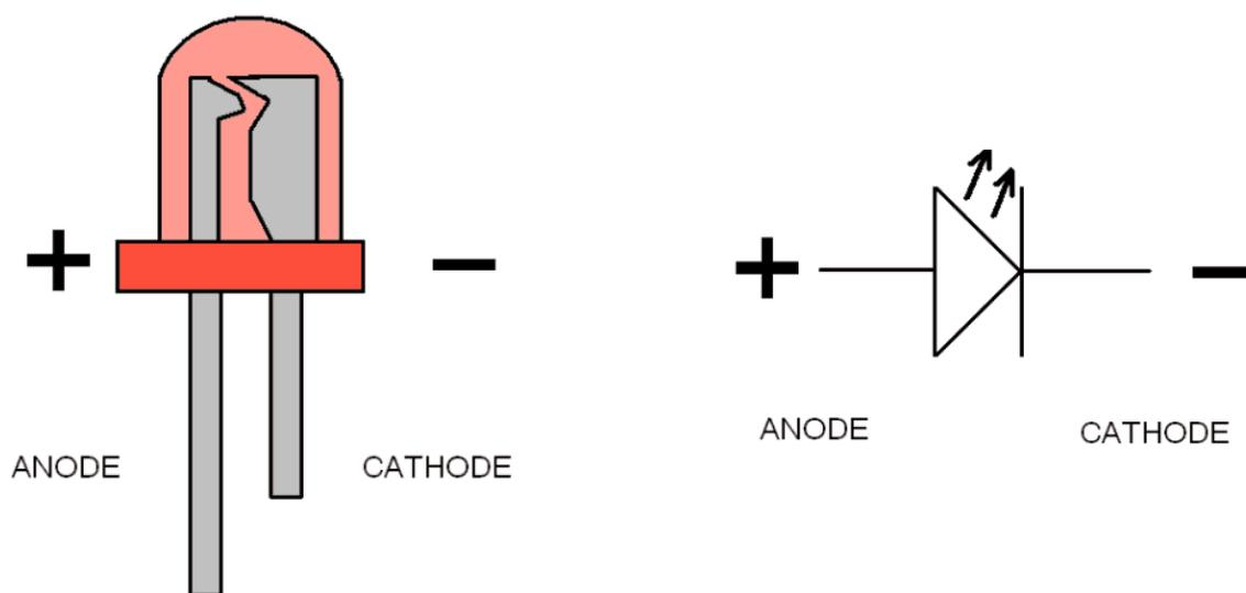
Figura 5: Terminais de um Led. Créditos: [Build-eletronic-circuits.com](http://Build-eletronic-circuits.com)
