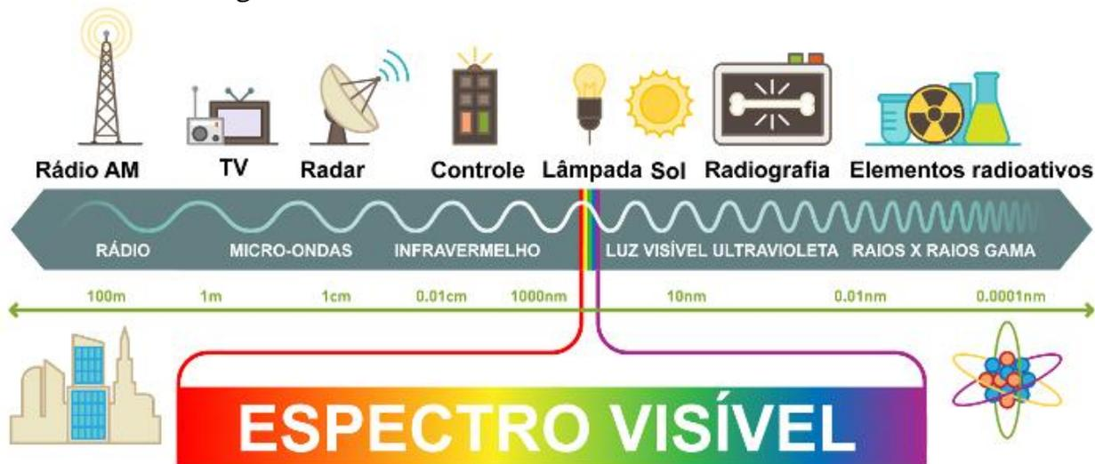
Para uma onda eletromagnética propagando no vácuo, temos:  $c = \lambda \cdot f$ , onde  $c$  é a velocidade da luz no vácuo,  $\lambda$  o comprimento de onda e  $f$  a frequência.
