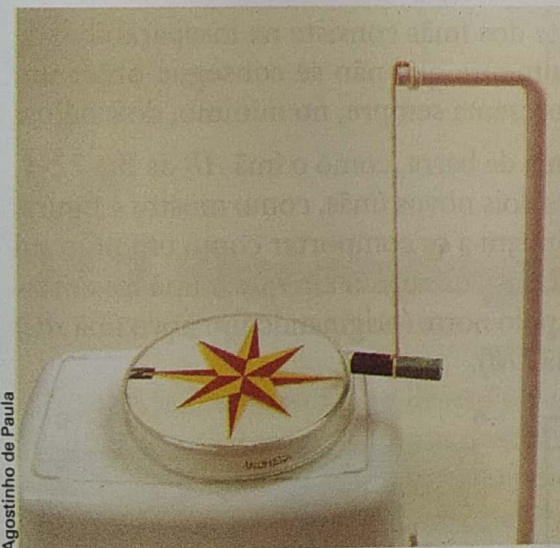
Um ímã suspenso livremente é orientado na direção norte-sul pelo campo magnético terrestre.
