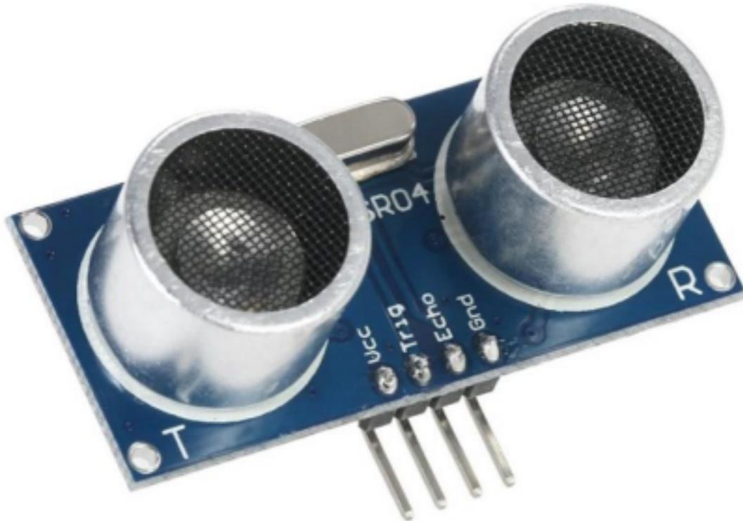
O **Sensor Ultrasonico HC-SR04** é aplicado com mais frequência em projetos de robótica, principalmente em chassis robóticos, robôs ou carrinhos. O sensor é capaz de medir com precisão (3mm de margem de erro) distâncias de 2cm até 4m.
